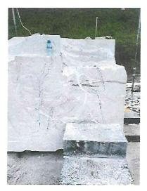
Luego de recibir el prisma de mármol se procede al dibujo en cada una de sus partes para analizar la conveniencia de partes para extracción de volúmenes para ser aprovechados.
